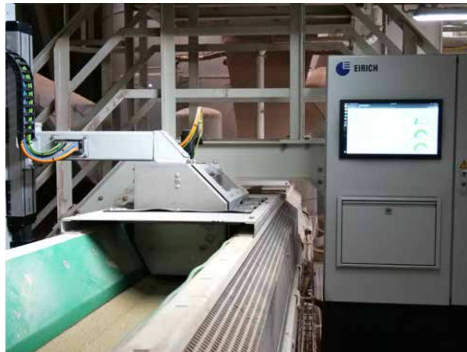
Optische Granulatvermessung durch den VC1
