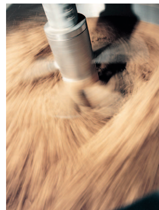
Mischgutstrom im EIRICH-Intensivmischer
