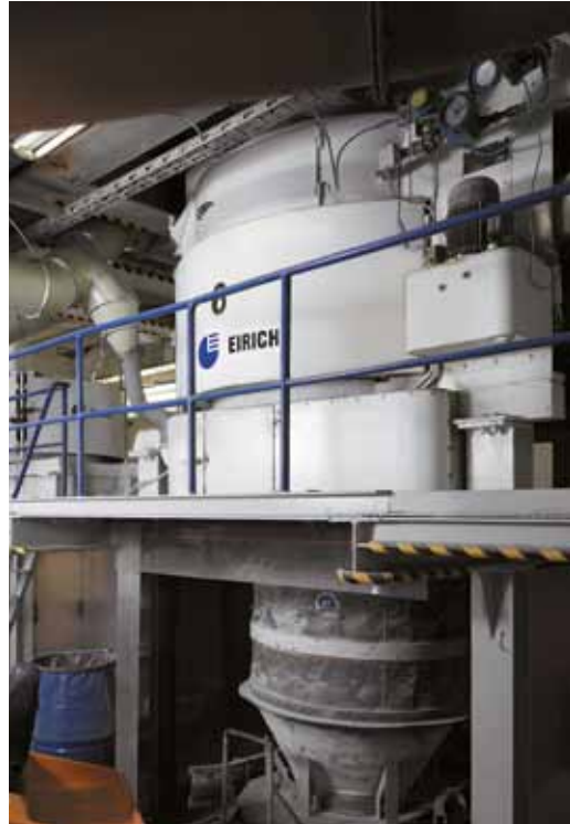
Mélangeur intensif EIRICH de type R, volume utile 1500 l Mélangeur intensif EIRICH de type D, volume utile 1500 l
