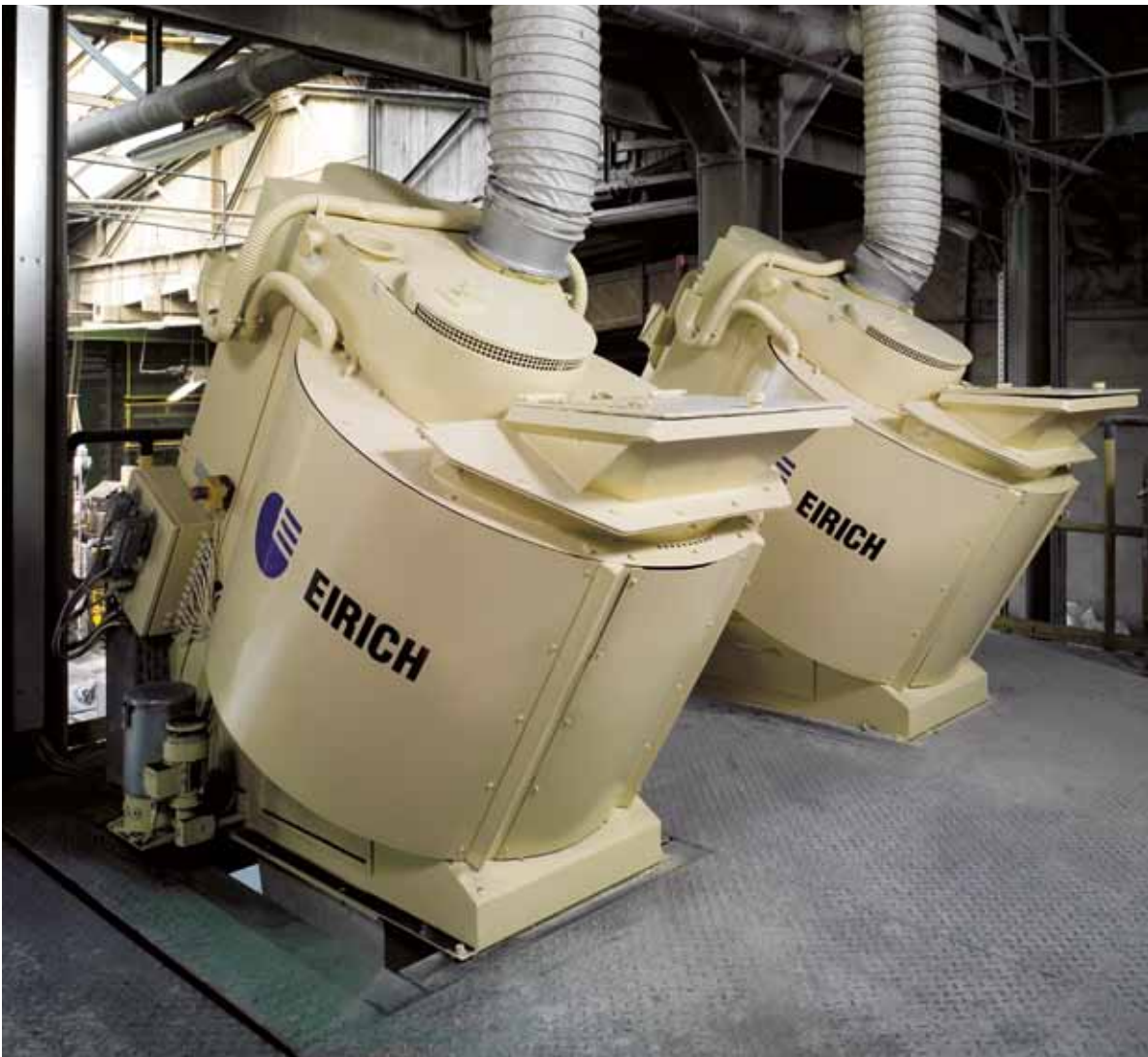
Deux mélangeurs intensifs EIRICH de type R avec chacun un volume utile de 250 l
