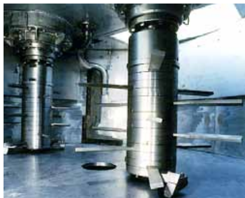
Innenraum eines EIRICH-MixSolver® Produktberührende Teile aus Edelstahl Dispergieren von Ton im EIRICH-MixSolver®
