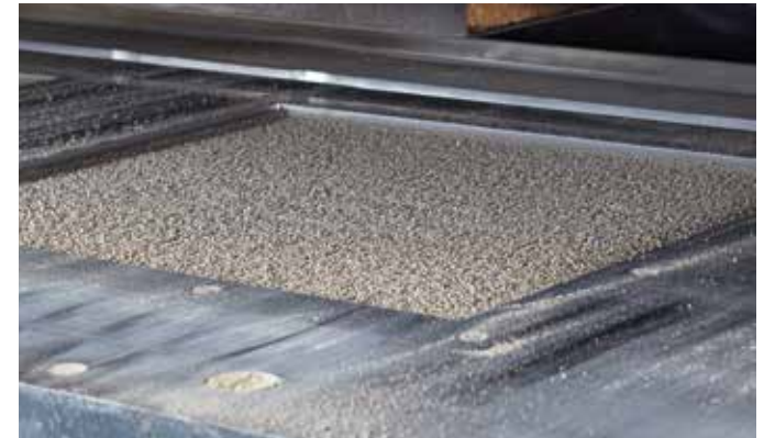
EcoPrep®-Granulate ermöglicht eine gleichmäßige Füllung der Pressform
