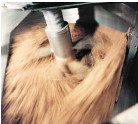
Courant de matière dans le mélangeur intensif EIRICH
