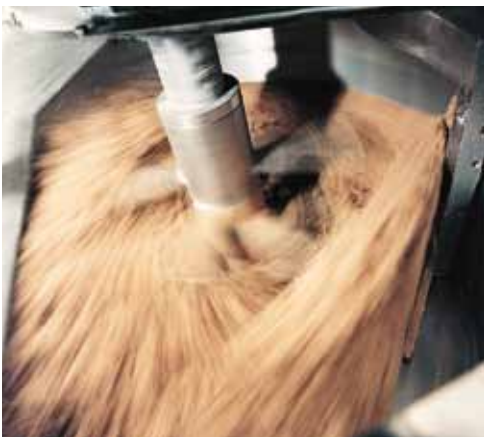
Mischgutstrom im EIRICH-Intensivmischer
