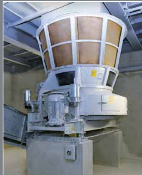
EIRICH-Waageinheit und Telleraufgeber
