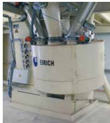
Mélangeur intensif EIRICH RV19 avec inclinaison de 10 %
