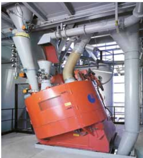
Bâtiment de l'usine Élévateur vertical au-dessus du mélangeur Mélangeur intensif EIRICH RV19 Sortie du produit fini avec ensacheuse
