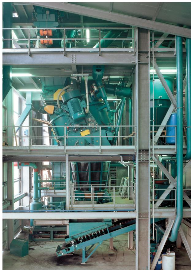
Abb. 4.1: Eirich-Aufbereitungsgruppe mit EvacTherm®-Mischkühler RV32VAC
