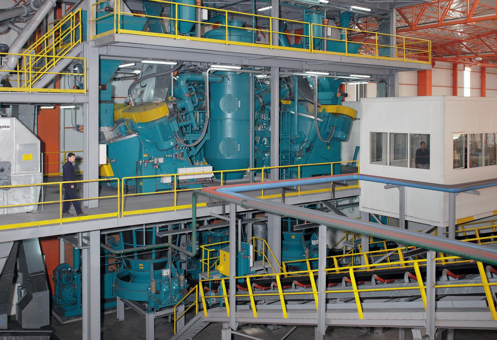
Abb. 6.1: Zwei Eirich-EvacTherm®-Mischkühler RV32 VAC (7 m<sup>3</sup>/Charge) für ca. 260 t/h Fertigsandbedarf.
