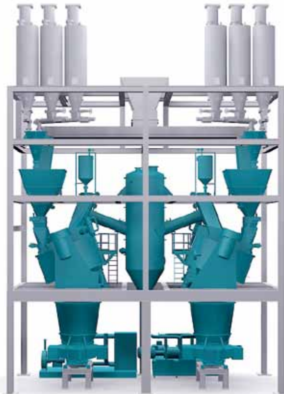
Abb. 6.2: Ausschnitt aus einem Aufstellungsplan einer Anlage mit einer Leistung von ca. 260 t/h Fertigsand. Er zeigt zwei EVACTHERM®-Mischkühler RV32VAC (7 m 3 /Charge) für mehrere Formanlagen mit gemeinsamer Vakuumkühlperipherie.
