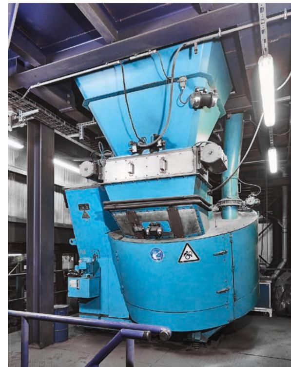
Bild 1: Der gebrauchte Eirich-Mischer wird in der Jürgens Gießerei mit Vorwasser gefahren.
