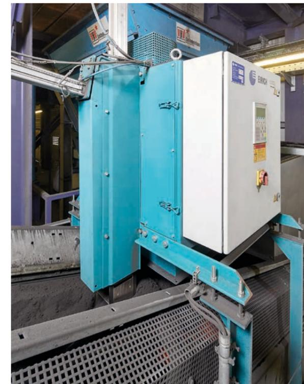
Bild 2: Das Inline-Prüfgerät AT1 besitzt eine autarke Vor-Ort-Steuerung.
