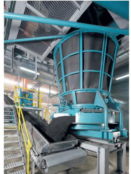
Bild 6: EIRICH Telleraufgeber Typ UE25
