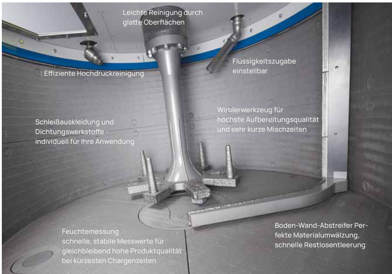
Die inneren Werte des Eirich-Mischer
