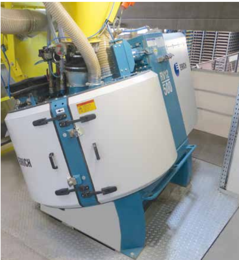
Mischer RV12: Optimale Zugänglichkeit in der fertigen Anlage
