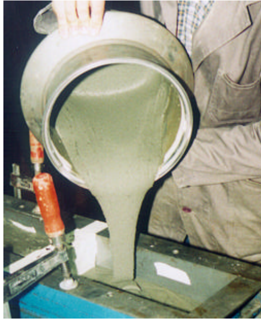
Bild 2: Zähflüssige Konsistenz des HLF-Betons (Mischung B)
