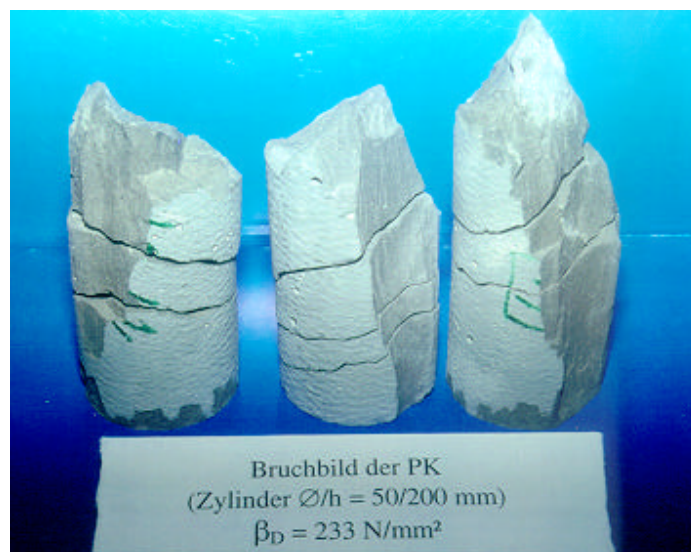
Bild 9: Sekundärer Zugbruch nach primärem Druckversagen von schlanken PK (Mischung A)
