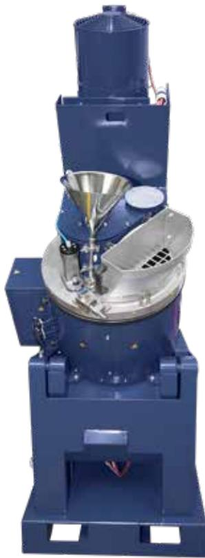
Mischer mit Infrarot-Heizung
